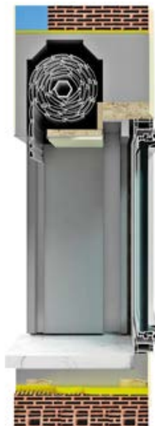
MONOBLOCCO ISPEZIONE INFERIORE
