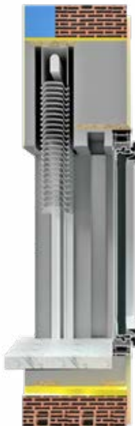
MONOBLOCCO CON PREDISPOSIZIONE PER FRANGISOLE
